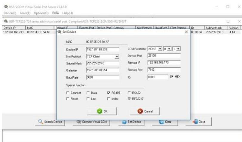
**Device IP** -> Indirizzo IP del modulo (assegnare un indirizzo libero della rete)
